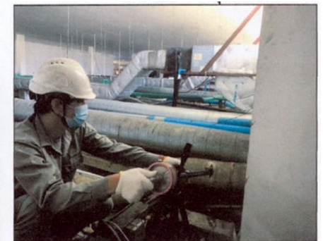
ภาพที่ 2 การเก็บตัวอย่างอากาศจากปล่องระบายอากาศ ปล่องระบายอากาศห้องล้างอุปกรณ์
